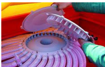
Kryt děliče zdvojnásobuje nebo ztrojnásobuje rozteč řádků. Výhodou je jednoduchá montáž. Varianty: 24/12, 24/8, 32/11, 32/16, 40/20.
