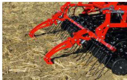
Předznamenání kolejových řádků značí stopy kolejových řádků pro postřikování a hnojení ještě nezvešlých plodin. Radličky zanechávají dobře viditelnou stopu v půdě. Znamenáky jsou ovládány pomocí elektroniky.
