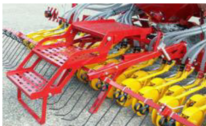
Schody se 3-mi stupni slouží k bezpečnému a pohodlnému plnění secího stroje. Díky schodům není problém naplnit násypku z pytlů.
