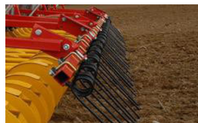
Zavlačovací rám slouží k zahrnutí osiva za secími botkami. Doporučeno pro DXD botky.
