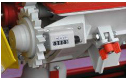
Mechanický hektaroměr Slouží k počítání zaseté plochy v ha.
