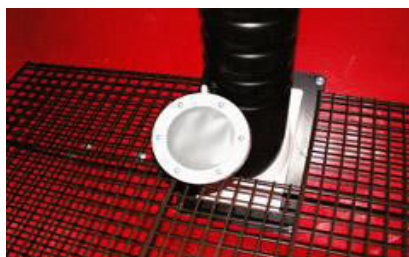
Signalizace hladiny osiva v násypce Akustická a světelná signalizace nízké hladiny osiva v násypce.
