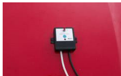
Kontrola otáček ventilátoru Světelně a akusticky signalizuje nízké otáčky ventilátoru.
