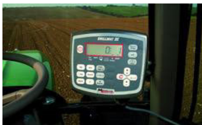
Elektronika Drillmat od firmy Müller – informace o následujících funkcích stroje : pracovní rychlost, vzdálenost, čas, celkové ha, výkon v ha/h, otáčky ventilátoru, otáčení dávkovače, stav osiva v zásobníku a tvorba kolejových řádků .
