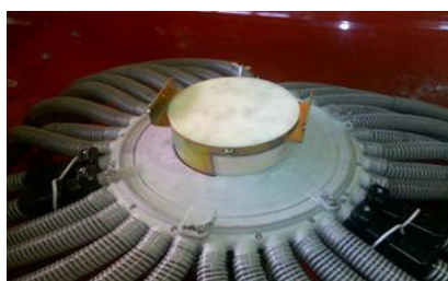
Odpojení 1/2 secího stroje – zasunutím redukce do dělicí hlavy.
